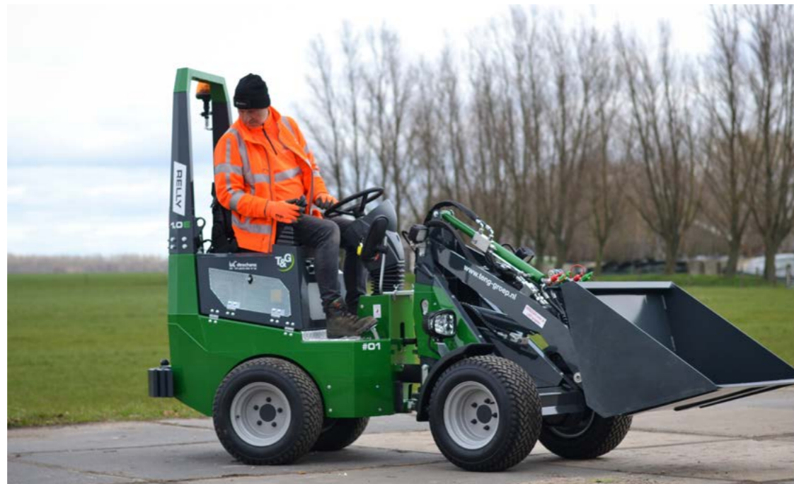
Deze nieuwe wiellader loopt volledig elektrisch, maar dat doet niets af aan de kracht. De Relly E100 gaat als een speer en is heel wendbaar. Dat is handig op terreinen met een smalle doorgang, zoals bij kinderdagverblijven.
